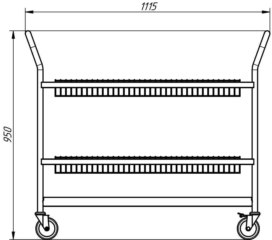
Тележка для сушки тарелок ТСТ является вспомогательным оборудованием на предприятиях общественного питания и используется для сушки и транспортировки тарелок. Количество одновременно загружаемых тарелок - 140 штук. Ванночка внизу тележки служит для сбора стекающей с тарелок жидкости. Тележка имеет четыре поворотных колеса большого диаметра, два из которых имеют стопор. Все детали тележки изготовлены из нержавеющей стали.
